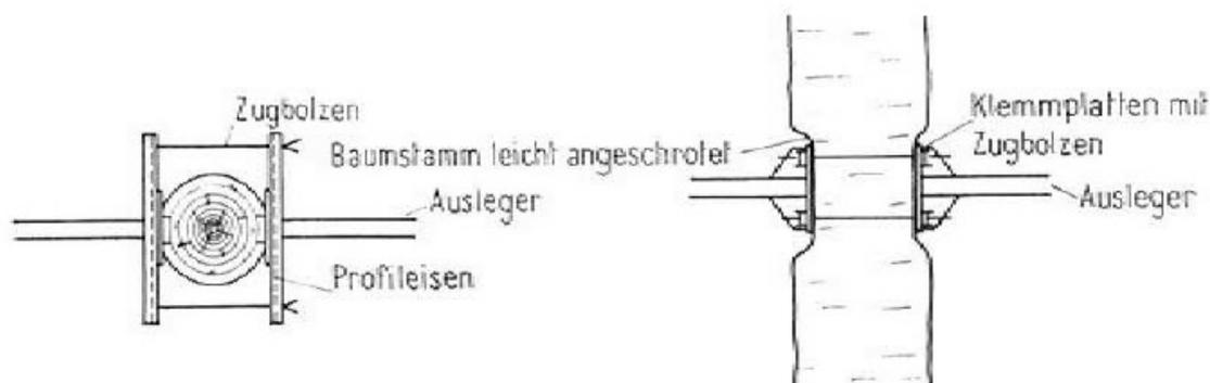
Abb. 13 Vorschlag zur Befestigung der Gehänge an Bäumen
